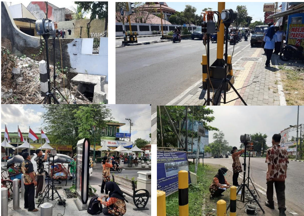
Gambar 2.22 Pengambilan Sampel Kualitas Udara Ambien Metode Aktif
