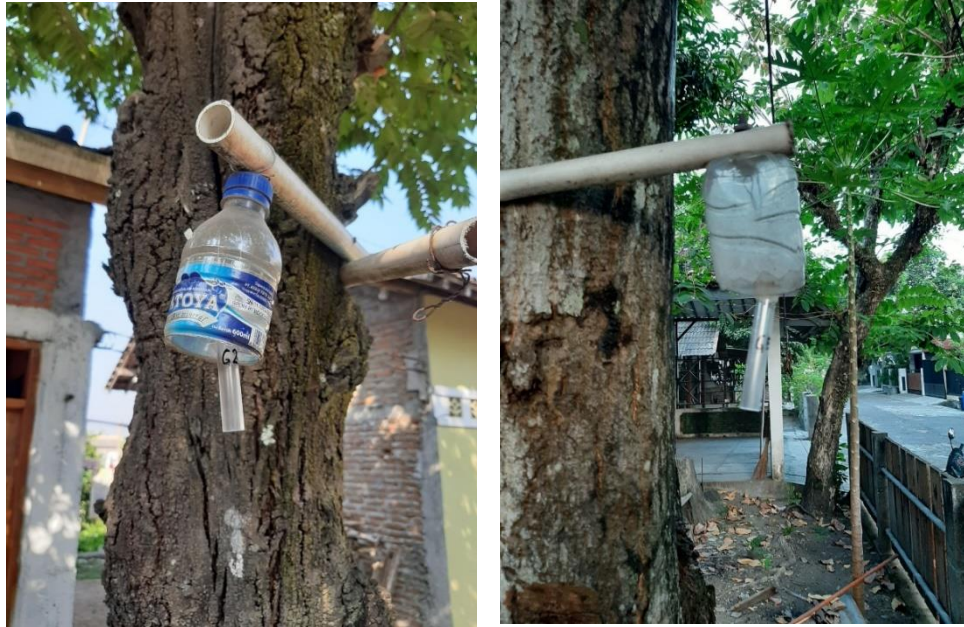
Gambar 2.21 Pemasangan sampel Kualitas Udara Ambien Metode Pasiif
