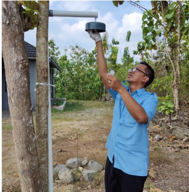
Gambar 17. Penempatan Alat Passive Sampler di Kawasan Industri Kabupaten Kulon Progo
