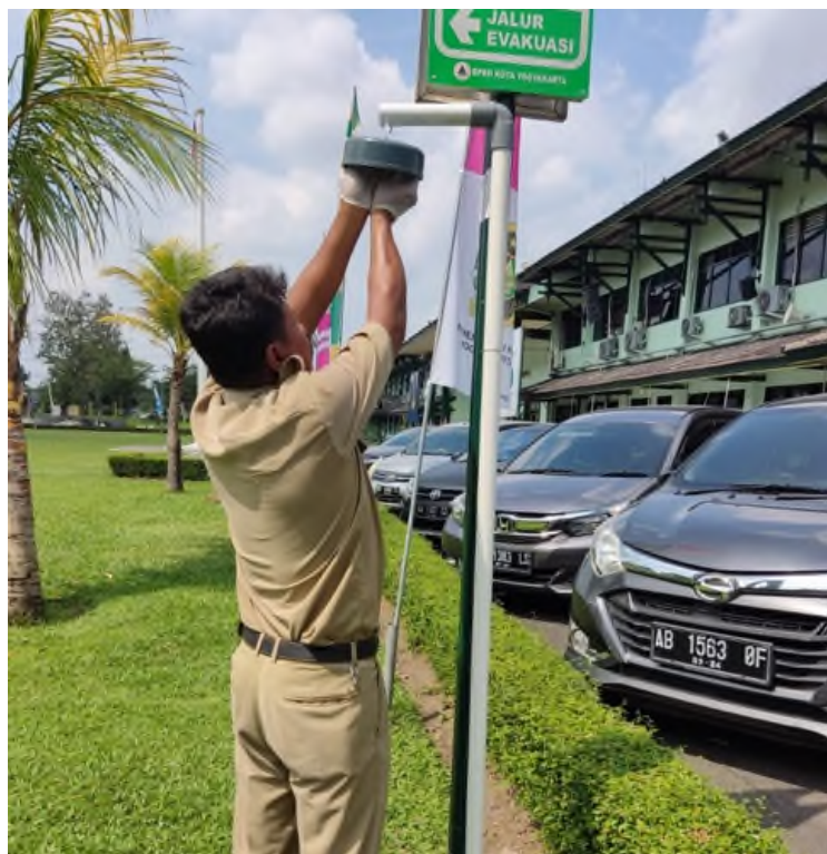
Gambar 16. Penempatan Alat Passive Sampler di Balaikota Yogyakarta
